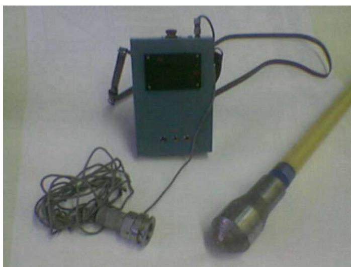
Рис. 2 – Функциональная схема и внешний вид прибора виброконтроля качества закрепления анкерной крепи.
